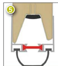
Profils bas à rupture de pont thermique
