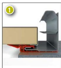
Joints latéraux à rupture de pont thermique
