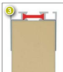
Profils haut à rupture de pont thermique
